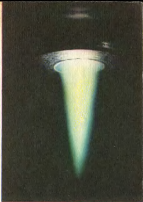
Рис. V. Струя «холодной» плазмы, бьющая из сопла плазмотрона. ►
