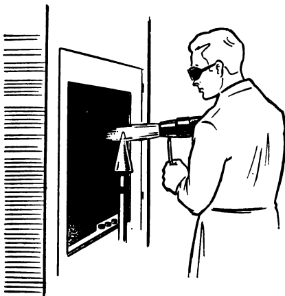
Рис. 2. Напыление оксида алюминия с помощью плазмотрона.
